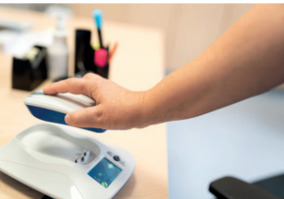
Die telemedizinische Kontrolle eines Defibrillators erfolgt über ein Abfragegerät.
